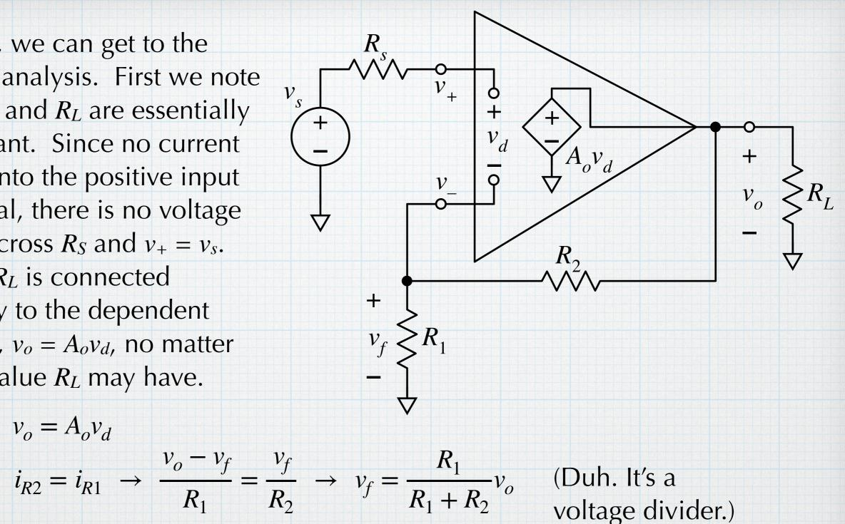
$$v_d = v_+ - v_f = v_s - v_f$$
